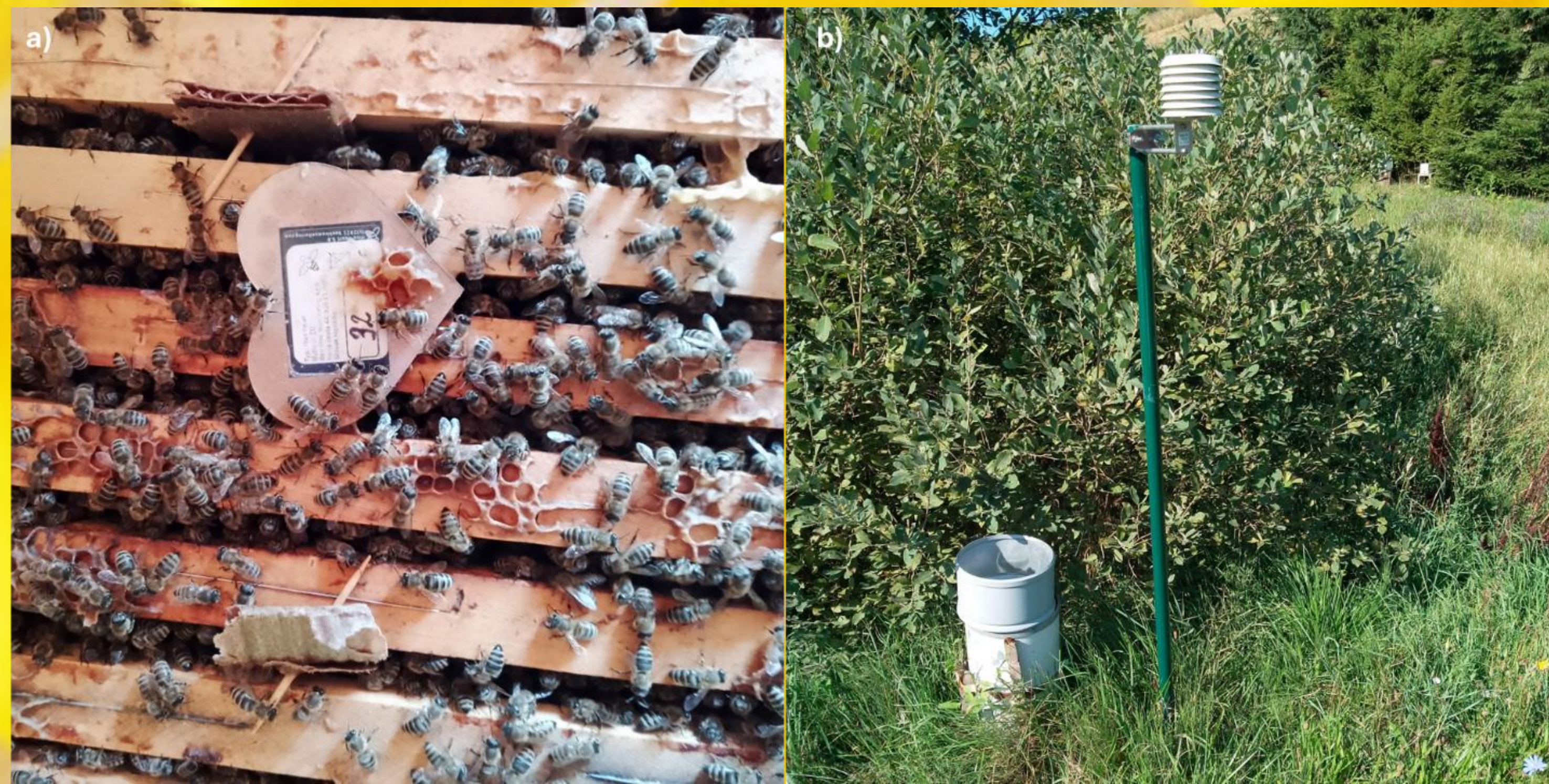
Obr. 2 Použité zariadenia na zber dát. a) „Srdce úľa“ na meranie vnútorných podmienok, b) Meteorologická stanica EMS Brno na meranie externých podmienok
